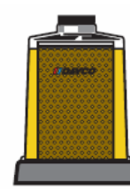
Фильтрующий элемент требующий замены. Уровень топлива достиг и постоянно находится у верхнего края фильтрующего элемента.
