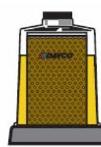
Фильтрующий элемент после продолжительной эксплуатации. Уровень положения топлива выше среднего.
