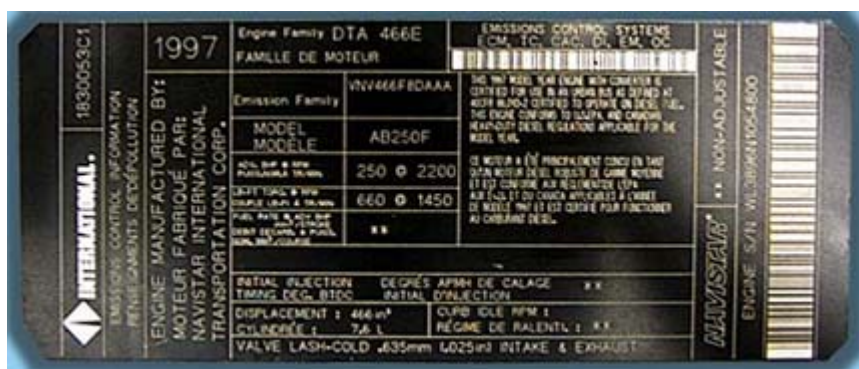
Рис.6. Пример таблички расположенной на клапанной крышке/впускном коллекторе.
