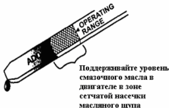
Рис.15. Проверка уровня смазочного масла щупом новой конструкции .
