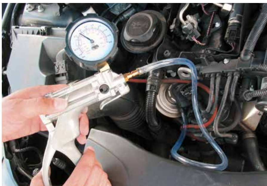
Слив жидкости или удаление воздуха из тормозной системы
